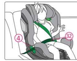
3. Posizionare la Sezione della Cintura sul Girovita (32) dall'altro lato della Base nella Guida della Cintura sul Girovita (4).
