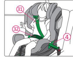
2. Posizionare la Sezione della Cintura sulla Spalla (31) e la Sezione della Cintura sul Girovita (32) sul lato della fibbia nella Guida della Cintura sul Girovita (4) della Base.
