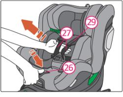
1. Premere il Pulsante di Regolazione dell'Imbracatura (27) e tirare la Cinghia sulla Spalla (26) verso di te il più possibile. Assicurati di tirare la cinghia sulla spalla da sotto il Paracolpi Toracici (29) come indicato.
