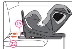
2. Posizionare il seggiolino per bambini sul sedile del veicolo e puntare entrambi i connettori ISOFIX (15) verso i Punti di Ancoraggio ISOFIX (22) nel sedile del veicolo.
