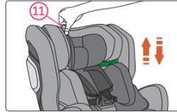
Tirare e tenere premuto l'Anello di Regolazione del Poggiatesta (11) sul retro del Poggiatesta per rilasciare il Poggiatesta. Spostare il Poggiatesta all'altezza corretta, posizionando le Guide della Cintura di Sicurezza appena al di sopra delle spalle del bambino. Quindi rilasciare l'anello per bloccare l'altezza del Poggiatesta.
