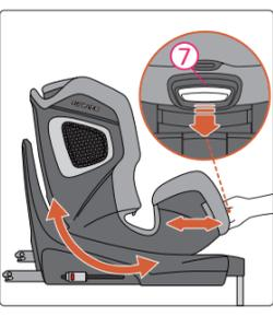
XENON 1 ha 3 posizioni di inclinazione in direzione rivolta in avanti e 3 posizioni di inclinazione in direzione rivolta all'indietro. Per regolare la posizione inclinata, tirare la Maniglia di Regolazione dell'Inclinazione (7) e far scorrere la Conchiglia del seggiolino per bambini spingendola e tirandola avanti e indietro contro la Base.
