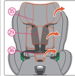
2. Rimuovi la copertura del poggiatesta (35). Sblocca l'Imbracatura a 5 Punti. Rimuovi i Paracolpi Toracici (36) e il Paracolpi per il Girovita (29).
