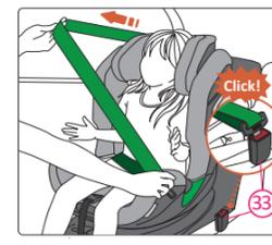
1. Sedere il tuo bambino nel seggiolino per bambini. Posizionare la Cintura di Sicurezza a 3 Punti del veicolo di fronte al bambino e bloccare la cintura nella Fibbia della Cintura di Sicurezza a 3 Punti (33) con un clic.
