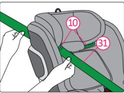
4. Instradare la Sezione della Cintura sulla Spalla (31) nella Guida della Cintura sulla Spalla verde (10) sotto il Poggiatesta, fino a quando giace completamente nella Guida della Cintura sulla Spalla. Verificare che la Sezione della Cintura sulla Spalla non sia attorcigliata.
