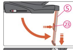
5. Assicurarsi che la Gamba di Supporto (5) sia nella posizione più dritta rispetto alla Base del Sedile. Premere il pulsante di rilascio della Gamba di Supporto (23) per allungare la Gamba di Supporto fino a quando la sua estremità inferiore tocca saldamente il pavimento del veicolo.
