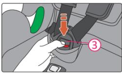
1. Ruota il seggiolino per bambini nella direzione rivolta in avanti. Premi il pulsante rosso sulla Fibbia dell'Imbracatura (3) e apri l'Imbracatura.
