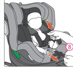
5. Tirare il Regolatore dell'Imbracatura a 5 punti (8) finché l'Imbracatura fissa saldamente il tuo bambino. Infine, tirare completamente verso il basso entrambi i Paracolpi Toracici.
