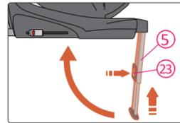
5. Non utilizzare la Gamba di Supporto (5) in questa configurazione. Prima dell'installazione, premere il pulsante di rilascio della Gamba di Supporto (23) e accorciare manualmente la Gamba di Supporto alla sua posizione più corta. Quindi piegare e racchiudere la Gamba di Supporto nella Base del Sedile.
